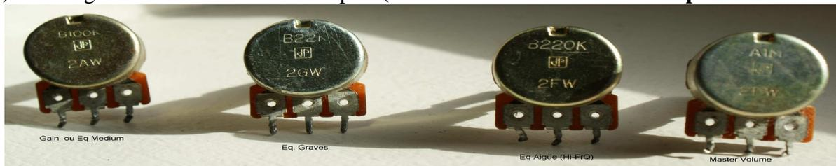
\* : 1 Még. Ohms pour le "Master volume", contre des 100 k. Ohms pour "Gain" ou "Eq. "
